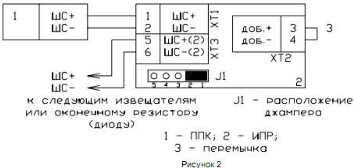
В дежурном режиме входная и выходная линии ШС «+» ИПР соединены накоротко, а устройство переключения индикации и токовой нагрузки ШС соединено с нормально-разомкнутыми контактами микропереключателя. Дежурный режим индицируется проблесковым сигналом зелёного цвета.
